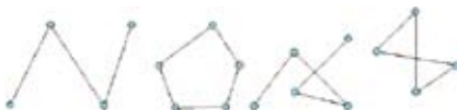
Slika 3. Primjer geometrije linije (s lijeva na desno): jednostavna linija, zatvorena linija, nejednostavna linija, nejednostavna zatvore- na linija
